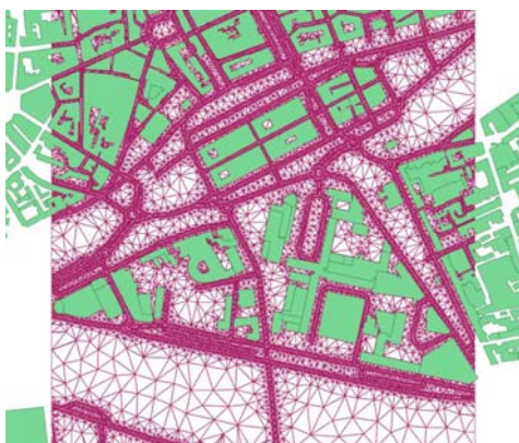
Définition des points de calcul par maillage adaptatif.
